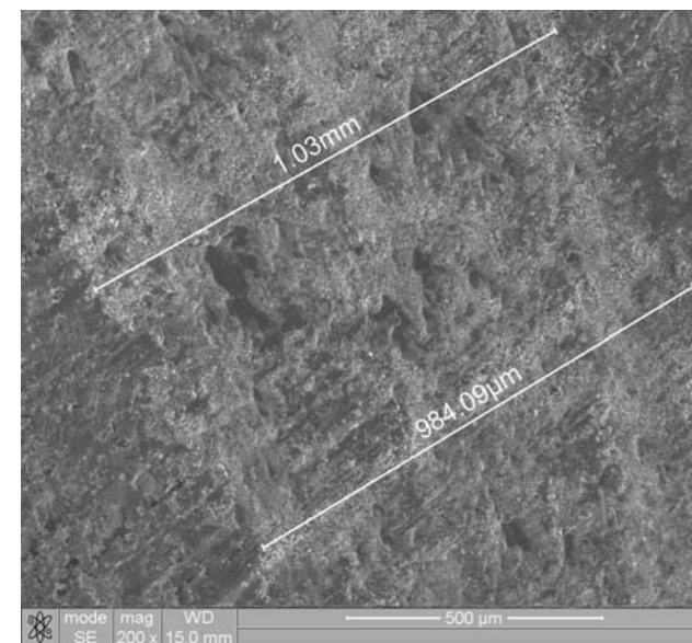
Рис. 1. Изображение зоны механического контакта износа поверхности образца
